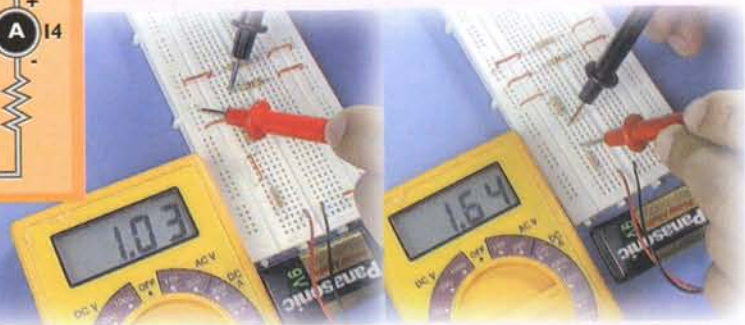
Figura 5.39. Midiendo las corrientes del circuito mixto
